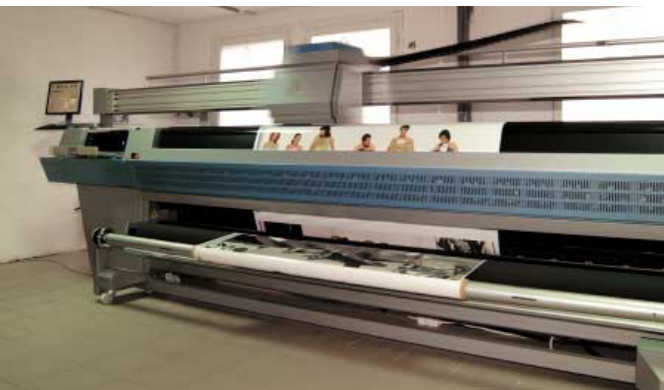
Jeti 3318 – to pierwsza nie tylko w Polsce, ale także w Europie solwentowa drukarka wielkoformatowa
